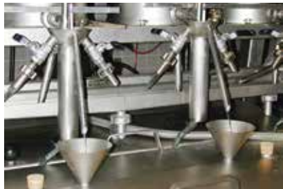
Im Kühler kondensieren die Alkoholdämpfe und rinnen als klares flüssiges Destillat heraus.
