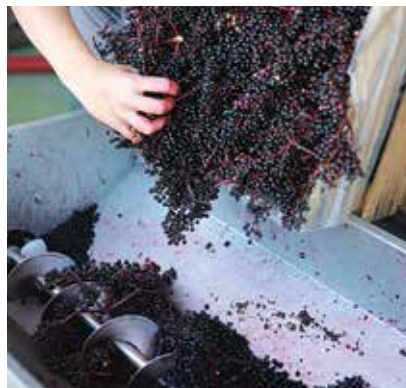
Holunderbeeren werden in der Abbeermaschine von den Dolden getrennt.
